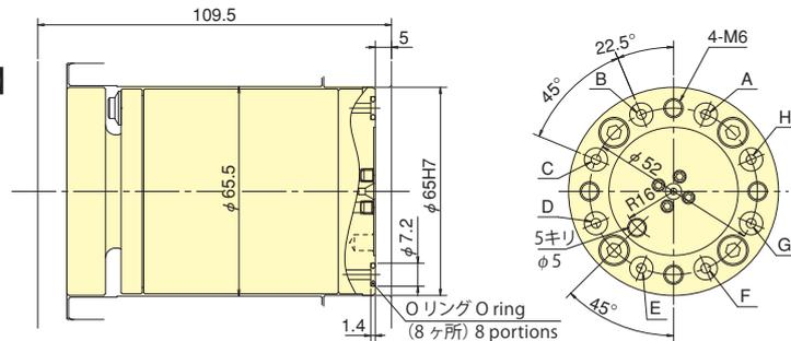
※外觀寸法は、上記のロータリジョイントなしと同じです。 ※Outline dimensions are the same as the above, without rotary joint
